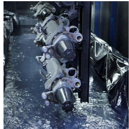
Die computergesteuerte BPW KTL zn -Anlage entspricht dem Hightech-Standard bei der Korrosionsschutz-Applikation in der PKW-Produktion und setzt weltweit den Maßstab für die Beschichtungsqualität von Anhängerfahrwerken.
