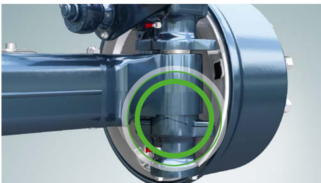
Lenkgehäuse bei Geradeausfahrt (0-Stellung)
