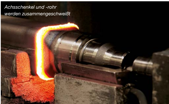
Achskörper nach dem Abbrennstumpf- schweißen
